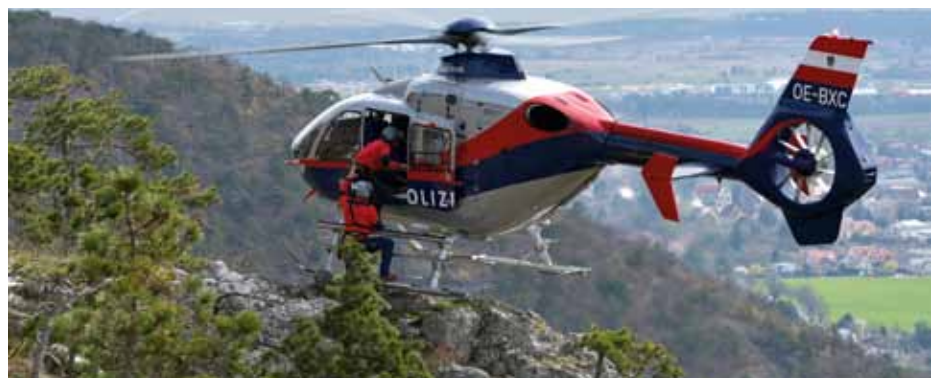
Aufnahme von Personen direkt in den Hubschrauber, der mit einer Kufe am Fels aufgesetzt hat
